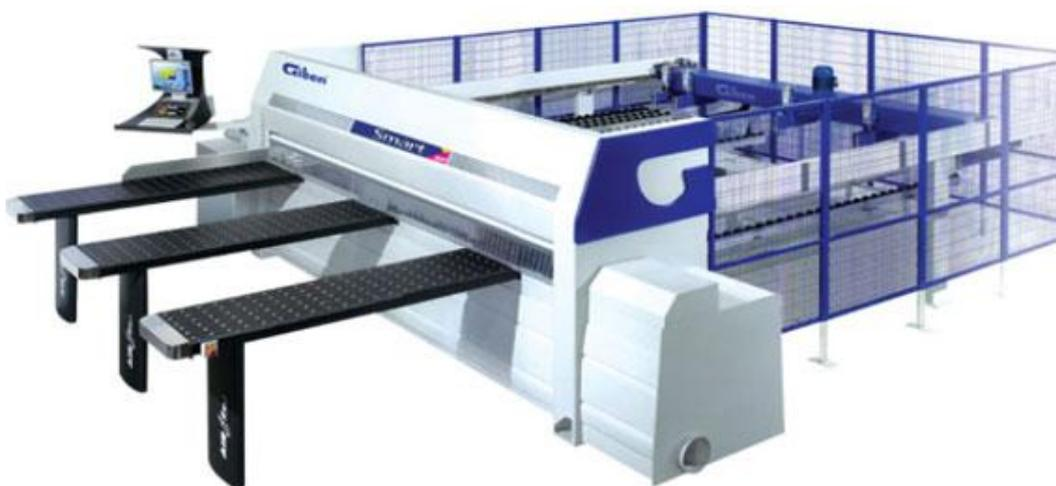
Станок мод. «SMART SPT» - форматно-раскройный центр с ЧПУ, основным отличием которого от мод. «SMART SP» является наличие подъемного стола для задней автоматической загрузки плитных материалов.
