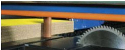
Выравнивающее устройство с прижимным роликом работает только перед смыканием прижимной балки. Штабель панелей отодвигается назад, в то время как выравнивающее устройство позиционируется, а затем штабель перемещается вперёд к отмеченным позициям, при этом выравнивающее устройство находится в контакте со штабелем.
