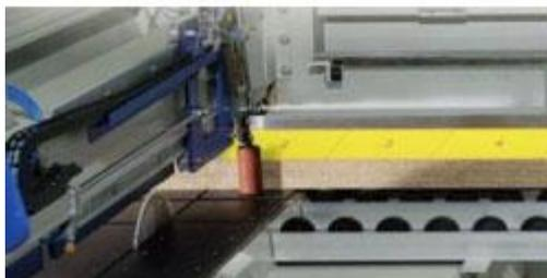
Во время цикла раскроя выравнивающее устройство с постоянным присутствием прижимного ролика функционирует только в начале цикла и никогда не функционирует во время последующего позиционирования толкателя. Прижимная балка опускается сразу после позиционирования толкателя, таким образом, выравнивающее устройство не влияет на производственный цикл.
