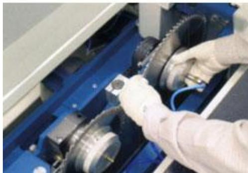
Крепление дисковых пил осуществляется вне рабочей зоны станка при помощи зажимных фланцев с пневматической системой блокировки.
