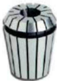
Позволяет быстро осуществлять смену инструмента с различными посадочными диаметрами (от 3 до 12 мм) при обработке изделий сложной конфигурации. Посадочные размеры цанг стандартизированы. Сокращается время переналадки станка и возрастает производительность работы.
